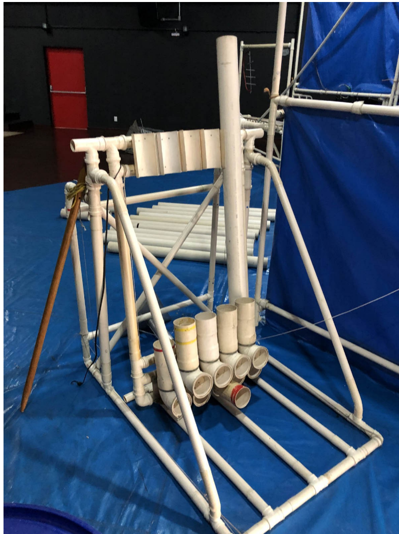
Figura 13: A "cama do Panzão": estrutura que sustenta os canos de PVC e permite a transição entre as posições vertical e horizontal dos canos (foto: Fernando Ribeiro, 2019).
