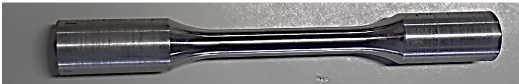
Figura 3.3 – Corpo de prova, sem microdefeitos, após acabamento superficial.
