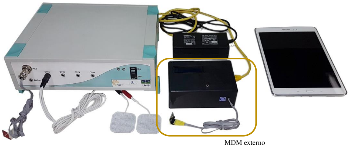
Figura B.1: Sistema de eletroestimulação proposto. Em destaque em linha amarela o módulo de detecção de movimento externo.
