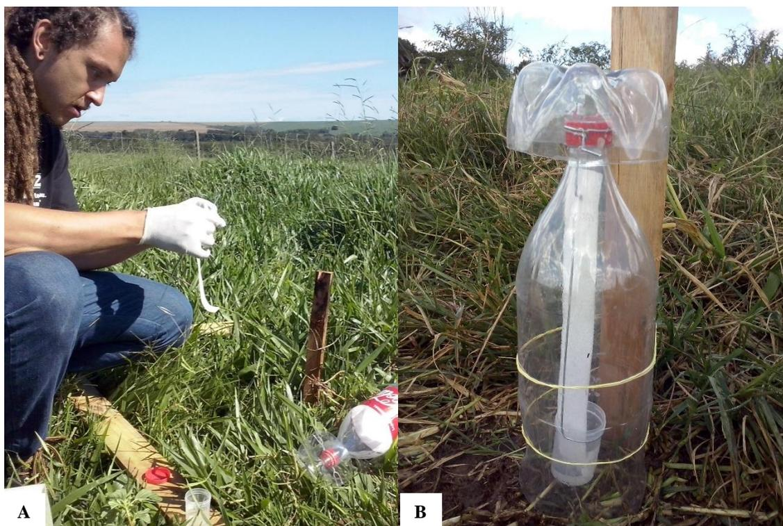
**Figura 6** – Câmara estática semi-aberta. A) Instalação. B) Detalhe da câmara instalada no campo.
