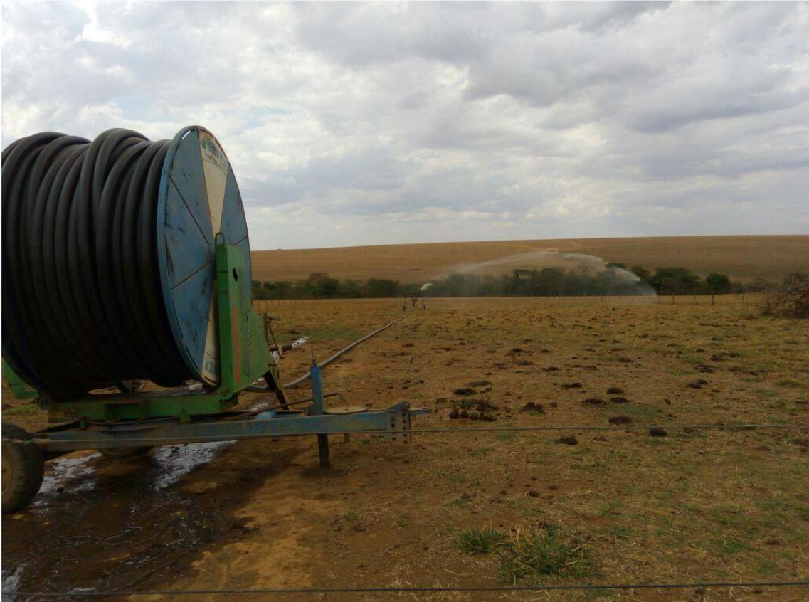
**Figura 4** - Canhão hidráulico com carretel enrolador em operação na fazenda Miunça.
