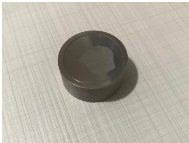
Figura 3-3: Amostra preparada para o ensaio de Microsonda Eletrônica.
