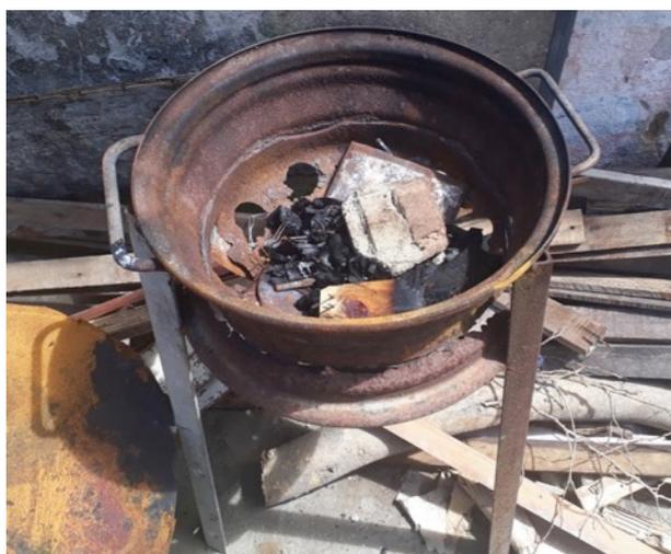
**Figura 71: Gambiarra Teimosense 21 - Churrasqueira de roda de carro e metais reaproveitados.**
