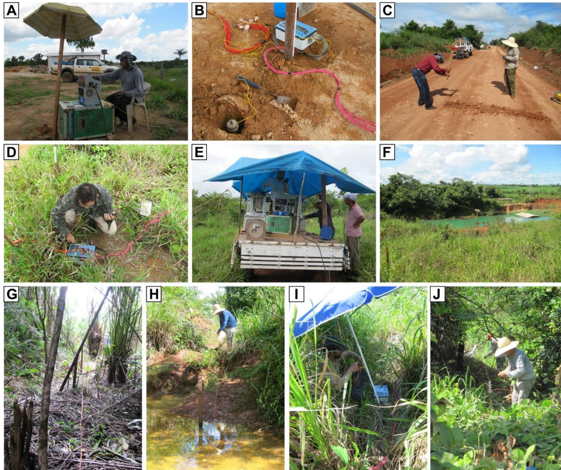
Figura 4.8 Fotos evidenciam algumas etapas da aquisição de dados geelétricos nos garimpos pesquisados. (A) Transmissor elétrico em operação. (B) Receptor de dados e eletrodo poroso usado para registro do potencial elétrico. (C) Valeta escavada para proteção dos cabos elétricos. (D) Operação do receptor em área de pastagem. (E) Barraca montada na carroceria de pick-up para a proteção do transmissor elétrico. (F) Cava emersa contornada durante o campo. (G) Picada aberta em mata de palmeiras. (H) Transposição aérea de cabos elétricos sobre um corpo d'água. (I) Picada aberta em área de pastagem. (J) Montagem dos eletrodos em área de mata fechada.
