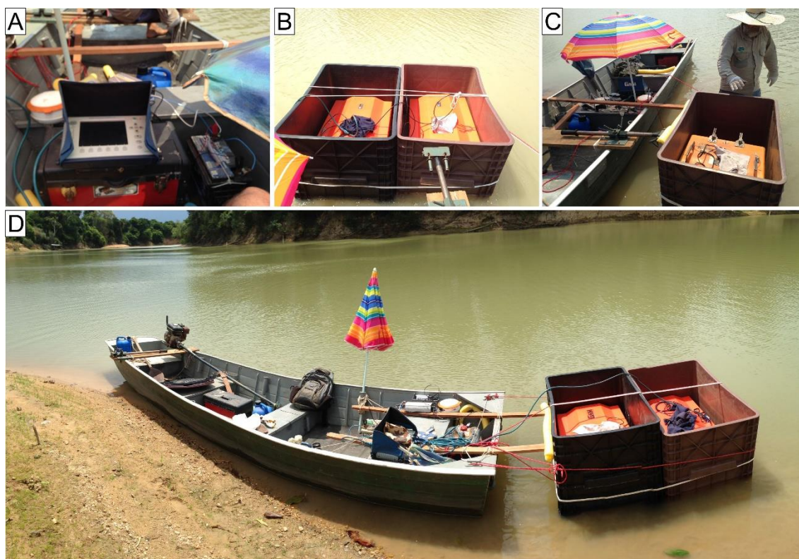
Figura 6.8 Fotos evidenciam a aquisição de dados de GPR na área do rio Peixoto de Azevedo, MT. (A) Sistema SIR3000 conectado ao GPS dentro do barco. (B) Antenas de 100 MHz dentro das caixas plásticas de transporte. (C) Antena de 200 MHz dentro da caixa plástica conectada ao barco de alumínio. (D) Caixas plásticas com as antenas de 100 MHz conectadas ao barco de alumínio.
