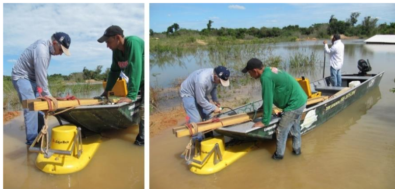
Figura 5.6 Fotografias evidenciam a fixação do equipamento SBP abaixo da proa do barco usado nas aquisições sísmicas que ocorreram no rio Peixoto de Azevedo, MT.
