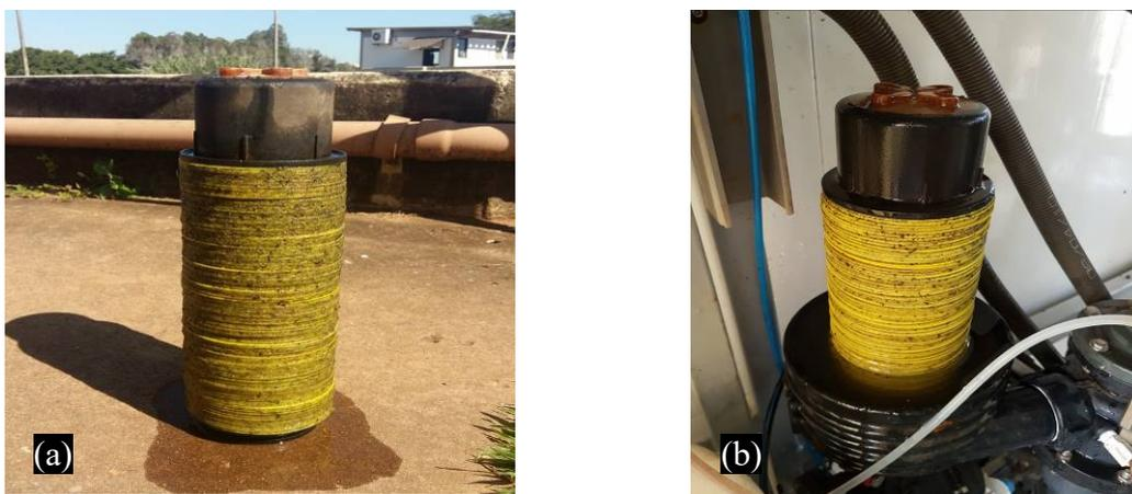
Figura 5.2- Imagens do pré-filtro de 200 µm da IP-UF: (a) Pré-filtro obstruído; (b) pré-filtro conectado na base da IP-UF sem a tampa de vedação.
