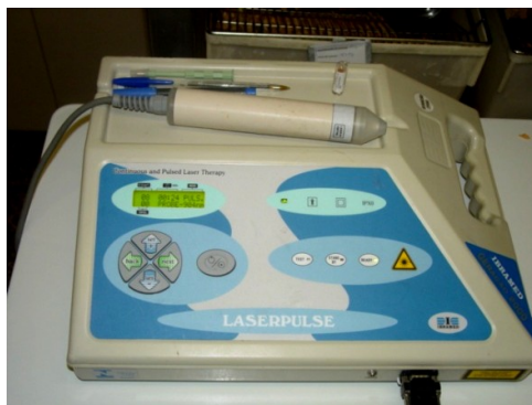
Figura 9: Aparelho de LASER com a caneta com comprimento de onda de 904 nanômetros.
