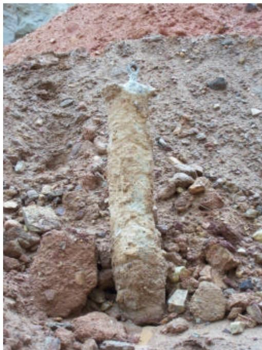
Figura 3.6 Ancoragem para a sonda rotativa
