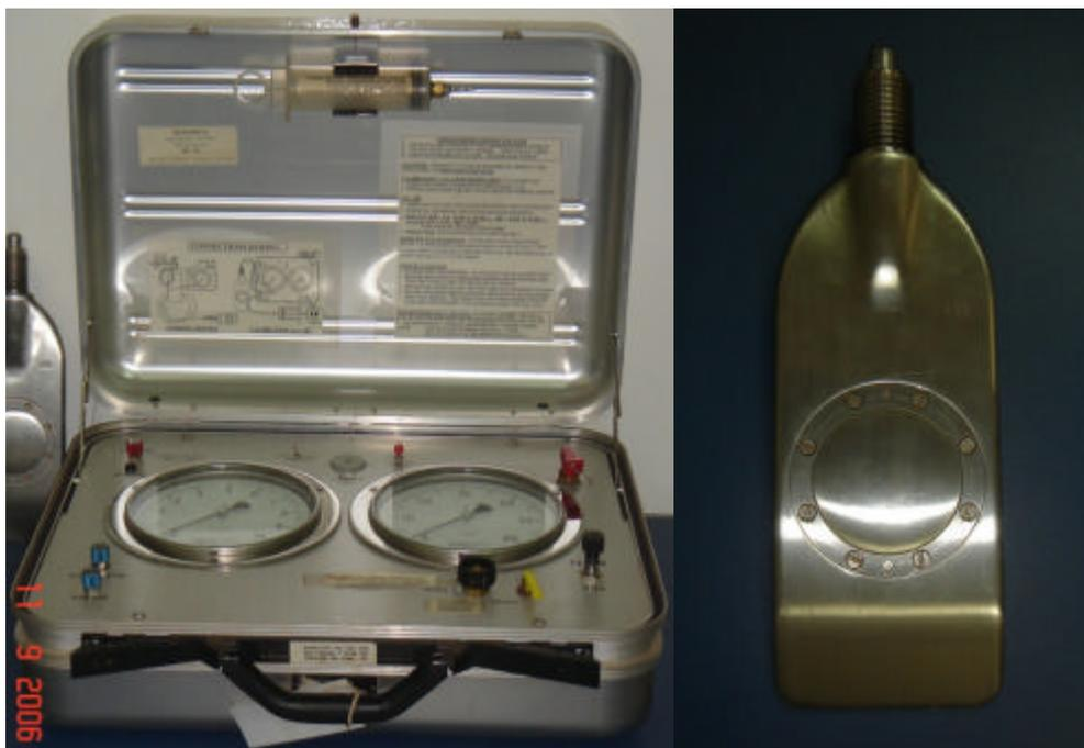
Figura 3.4 Equipamento DMT: unidade de controle e lâmina
