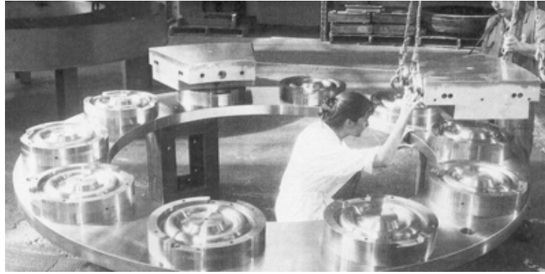
Figura A.4- Montagem dos patins sobre o conjunto de membranas do mancal escora.
