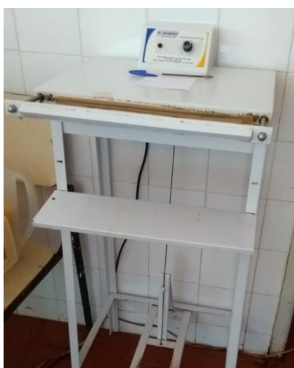
Figura 31 - Máquina seladora de pedal para embalagem de castanha torrada de baru
