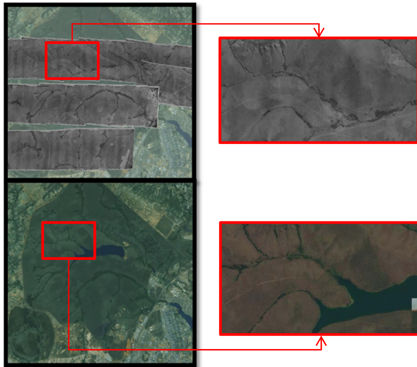
Figura 36 - Exemplo de área após o georreferenciamento das linhas de voo
