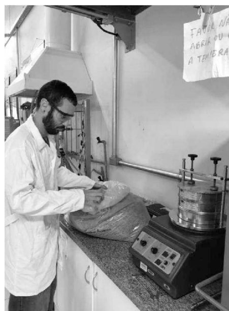
Figura 15: Agitador de partículas
