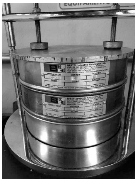
Figura 14: Montagem das peneiras
