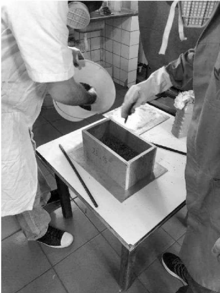
Figura 22: Caixa de compactação
