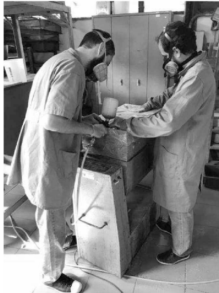
Figura 19: Aplicação do adesivo
