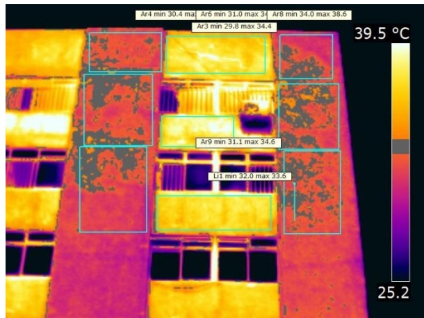
Figura A-18: Descolamento cerâmico no momento de máximo contraste. Fachada Leste 1 região C3.
