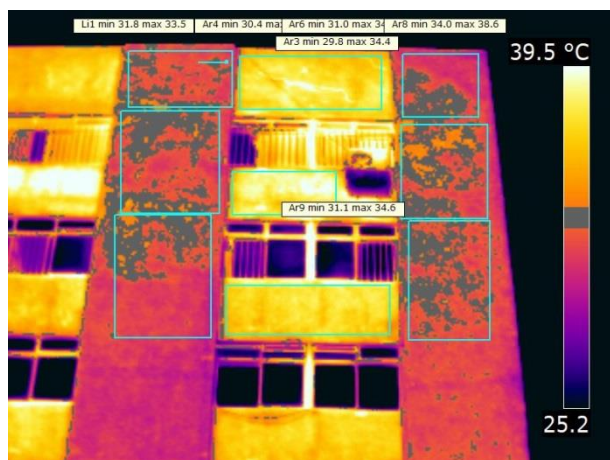
Figura A-14: Descolamento cerâmico no momento de máximo contraste. Fachada Leste 1 região A1.
