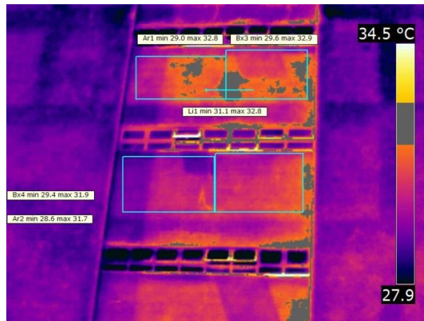
Figura A-4: : Descolamento cerâmico no momento de máximo contraste. Fachada Norte região D4.
