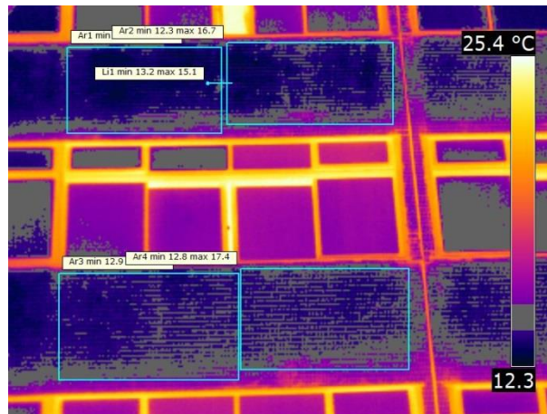
Figura D-28: Descolamento cerâmico no momento de máximo contraste. Fachada Oeste 3 região C2.
