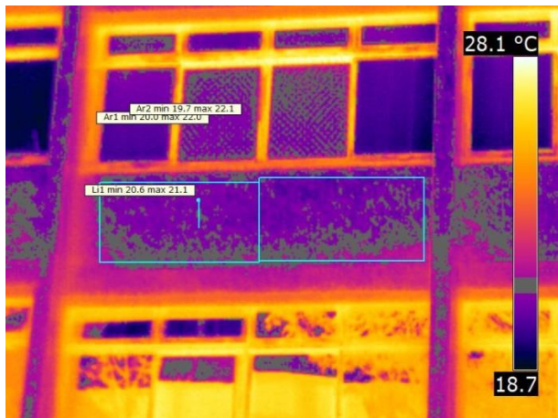
Figura C-22: Descolamento cerâmico no momento de máximo contraste. Fachada Oeste 1 região E1.
