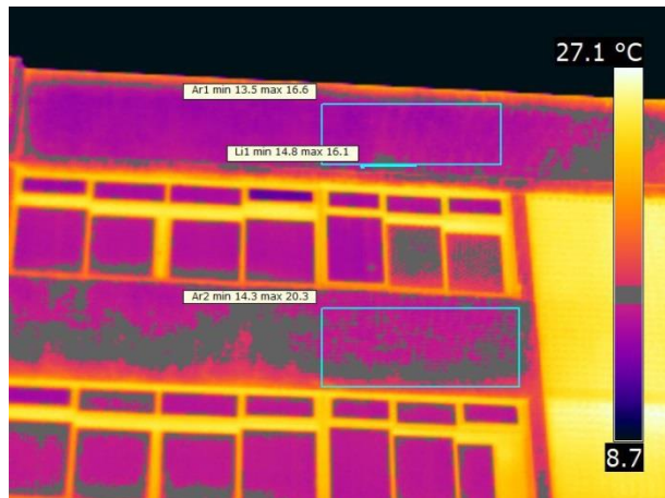
Figura D-30: Descolamento cerâmico no momento de máximo contraste. Fachada Oeste 4 região A3.
