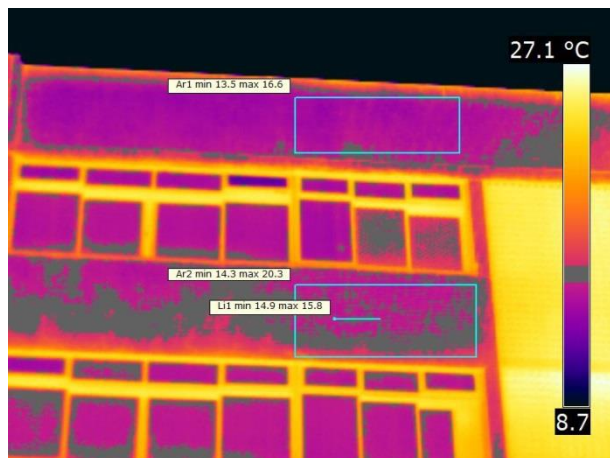
Figura D-33: Descolamento cerâmico no momento de máximo contraste. Fachada Oeste 4 região B3.
