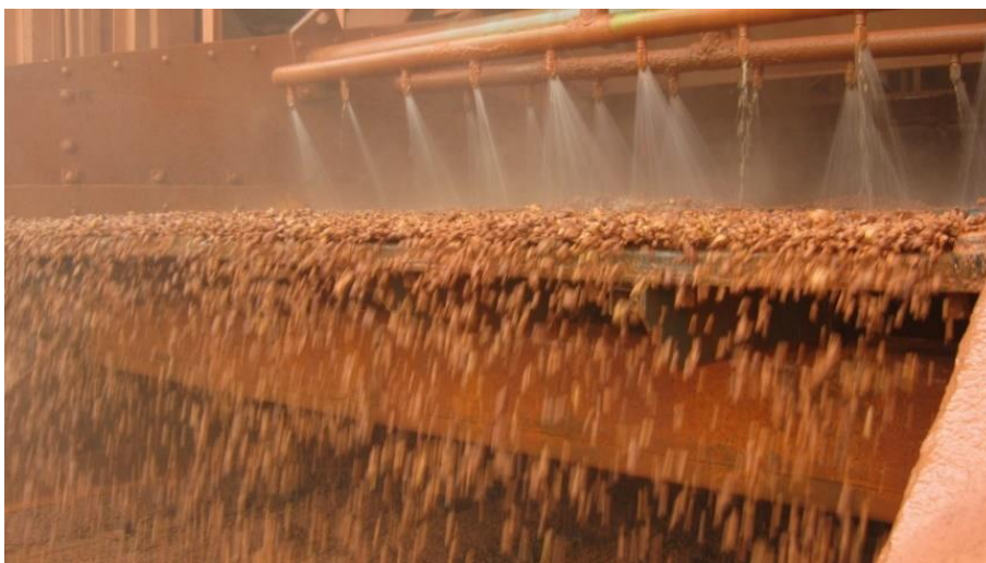
Figura 3. 19 - Detalhe de lavagem do minério na planta de beneficiamento.
