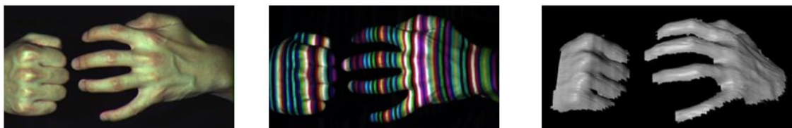
Figura 18 - Princípio da Luz Estruturada
