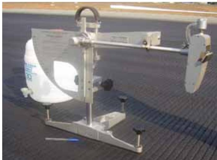
Figura 3.6. Ensaio de Pêndulo Britânico
