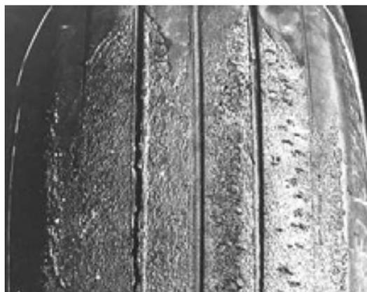
Figura 2.18. Banda de rodagem de um pneu aeronáutico após hidroplanagem por desvulcanização (Goodyear, 2004).
