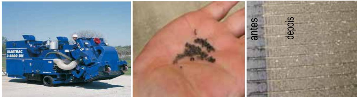
Figura 3.9. (a) Shot Blast; (b) Esferas de aço (granalha); (c) Pavimento desemborrachado (Blastrac, 2007).
