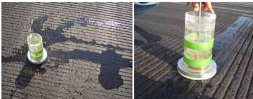
Figura 5.15. Drenômetro na Pista do AIB (a) grooving emborrachado; (b) grooving desemborrachado.
