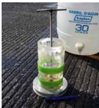
Figura 4.20. Drenômetro (LER-CEFTRU/UnB).
