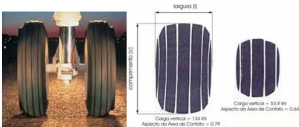
Figura 2.20. (a) Trem de pouso principal; (b) Área de contato pneu-pavimento (Modificado: Rodrigues Filho, 2006).
