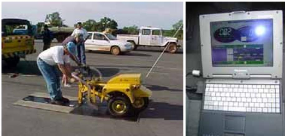
Figura 4.21. MuMeter: (a) calibração; (b) aquisição de dados (Modificado: Rodrigues Filho, 2006).
