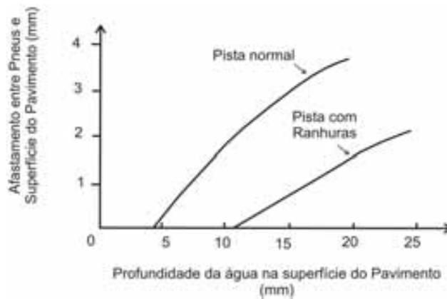
Figura 2.25. Lâmina d'água *versus* deslocamento do pneu (Modificado: Horne, 1963).
