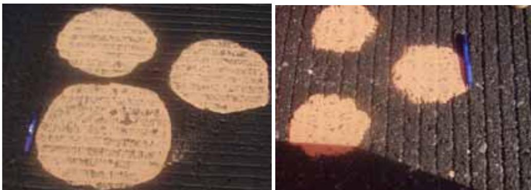
Figura 4.18. Mancha de areia na pista do AIB (a) situação emborrachada; (b) pavimento desemborrachado.
