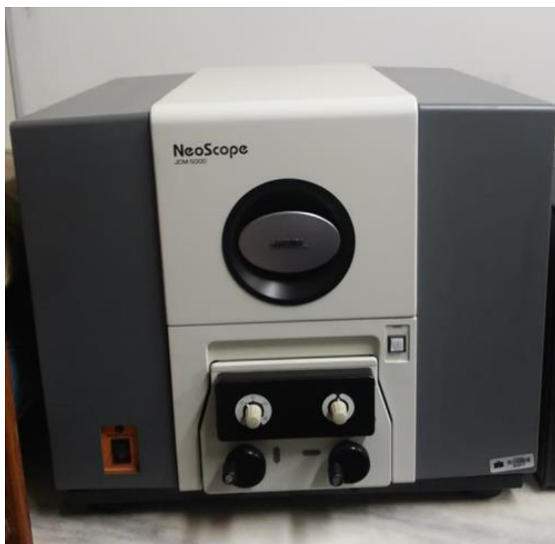
Figura 3.6 – Microscópio eletrônico de varredura utilizado na análise visual dos agregados
