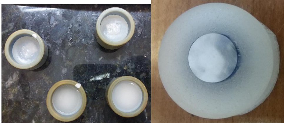
Figura 46: Fotografia de corpos de provas em processo de embutimento
