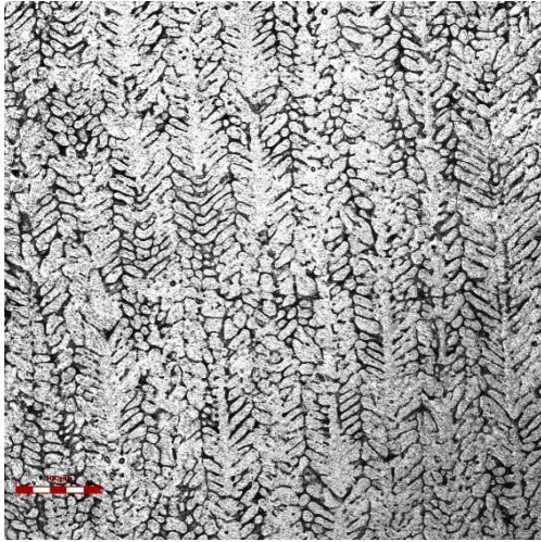
Figura 53: Microestruturas dendríticas obtida da liga a) Al-0,8%Nb, b) Al-1,2%Nb a partir de cortes na seção longitudinal ; Posições em relação a interface metal/molde: 18mm, 22mm e 27mm (Silva, J. I. S. 2017).
