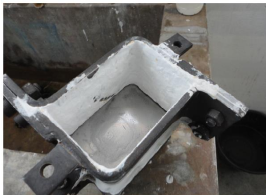
Figura 39: Lingoteira após aplicação de cimento a base fibra cerâmica sílico-aluminosa (SILVA, J. I. S. 2017).
