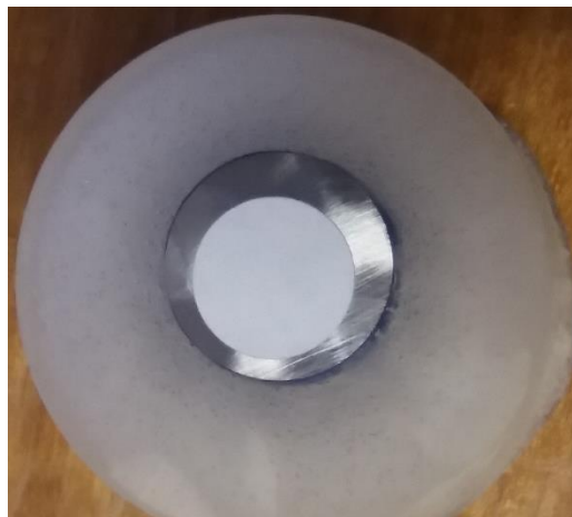
Figura 47: Fotografia do processo de delimitação da área de contato dos eletrodos.
