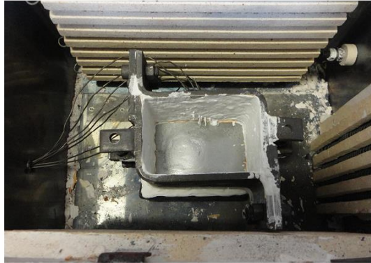
Figura 40: Posicionamento dos termopares no interior da lingoteira (SILVA, J. I. S. 2017).
