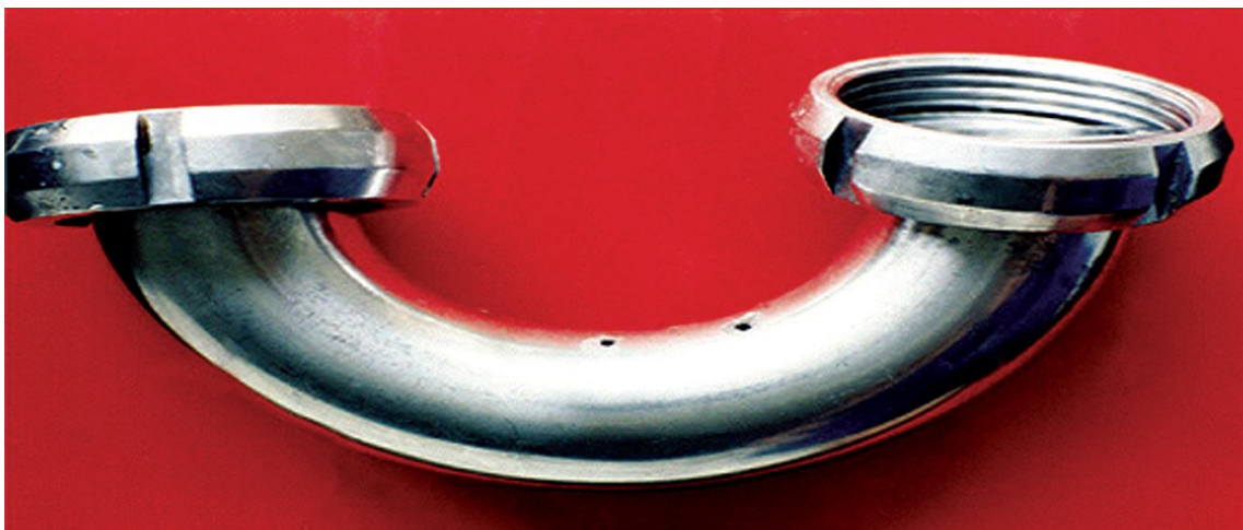
Figura 4: Corrosão por pitting (Gentil 1996)
