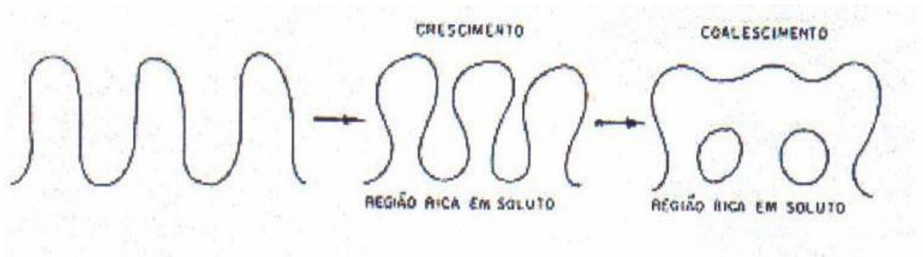
Figura 25: Esquema ilustrativo da formação das regiões ricas em soluto no fenômeno do coalescimento dos ramos dendríticos secundários (Chien & Kattamis, 1970; Flemings, 1974; Garcia, 2001, Santos, 2015)
