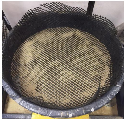
Figura 3.29: Instalação da camada de reforço.
