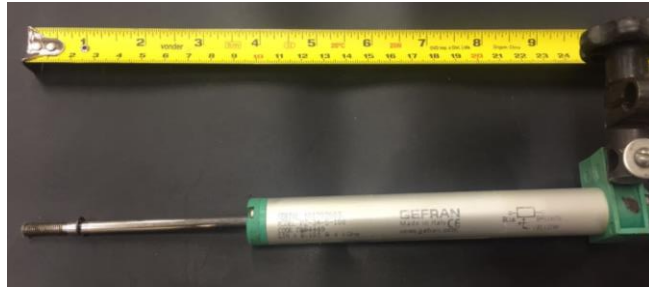
Figura 3.20: Transdutor de deslocamento linear adotado nos ensaios.
