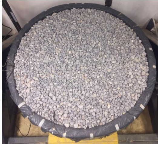
Figura 3.30: Camada de aterro finalizada.
