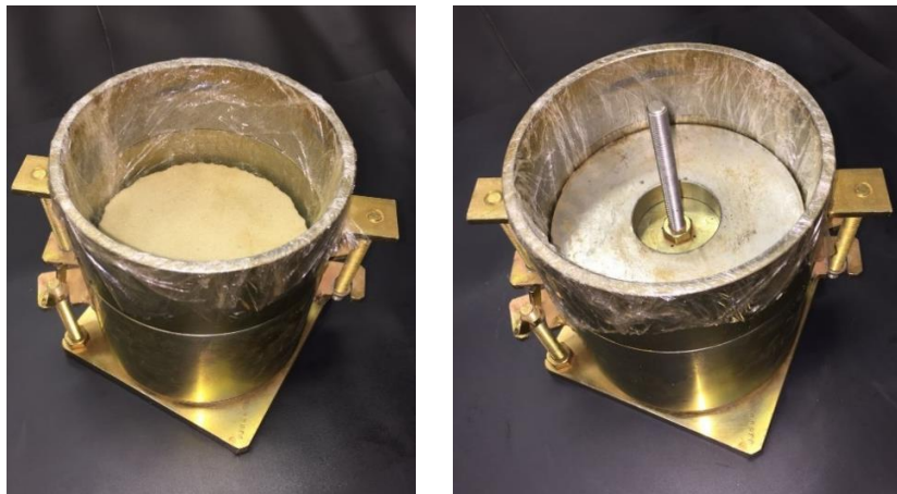
Figura 3.11: Montagem do ensaio de compressibilidade da espuma.
