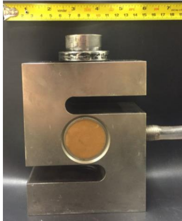
Figura 3.17: Célula de carga utilizada nos ensaios.
