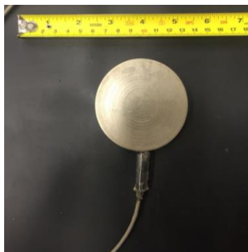
Figura 3.18: Célula de tensão total usada na pesquisa.
