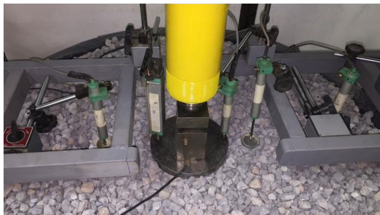
Figura 3.31: Localização da instrumentação superficial.
