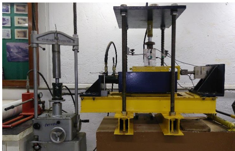
Figura 3.8: Equipamento de cisalhamento direto de médio porte.
