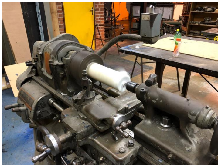
Figura 3.8: Molde de parafina em processo de secagem num torno mecânico.
