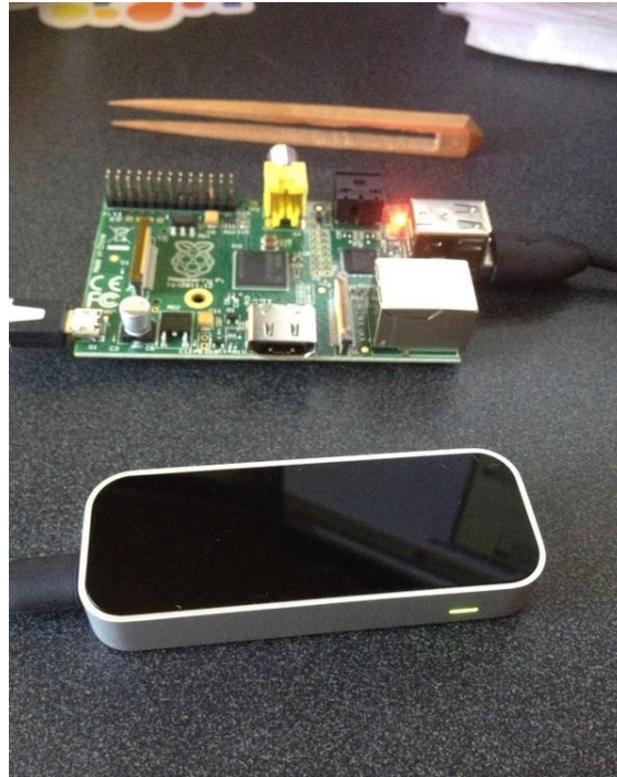
Figura 25 – Teste realizado com Raspberry conectada em um Leap Motion .
