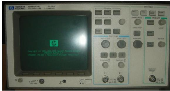
Figura 4.30 - Osciloscópio HP 54600A
