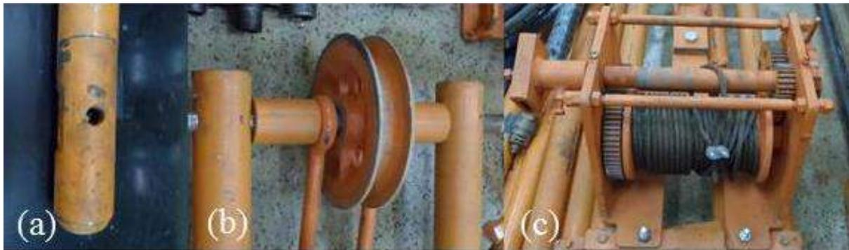
Figura 2.13 – (a) Amostrador tipo Raymond, (b) roldana e (c) corda – cabo de aço.
