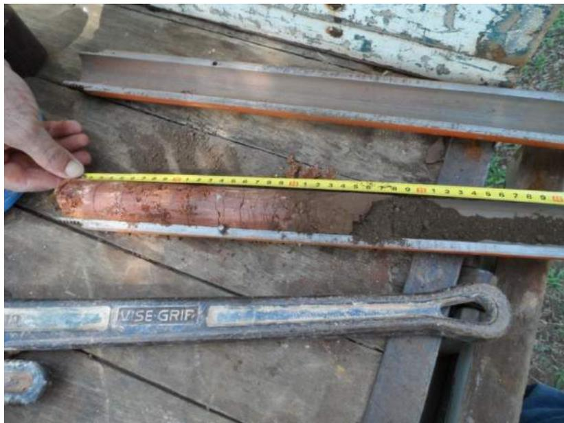
Figura 3.8 – Coleta de amostra retida no amostrador bipartido.
