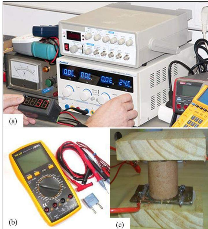
Figura 3.11 – (a) Fonte de corrente contínua (b) Multímetro (c) Capacete de contato.
