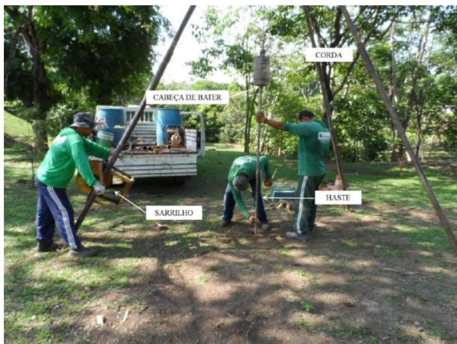
Figura 2.14 - Equipamento de sondagem à percussão montado e em operação.
