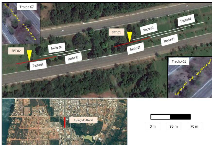
Figura 3.5 - Disposição das seções de resistividade elétrica para a região do Espaço Cultural.
