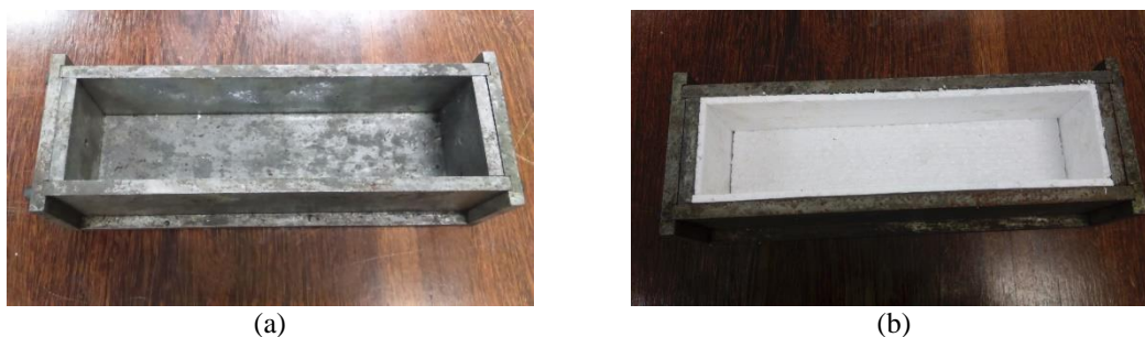
Figura 2: Forma prismática 75x75x285mm (a) e a mesma forma forrada com poliestireno expandido (b)
