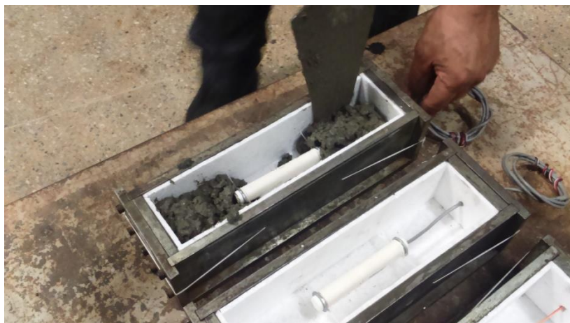
Figura 4: Moldagem do corpo-de-prova com extensômetro embutido
