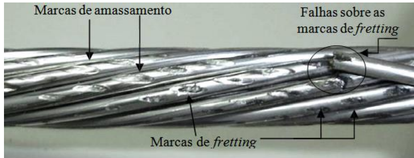
Figura 1.2. Cabo ACSR com marcas de amassamento e fretting (FADEL, 2010).
