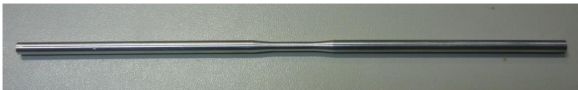
Figura 3.6. Fio sem entalhe da liga de alumínio 6201-T81.
