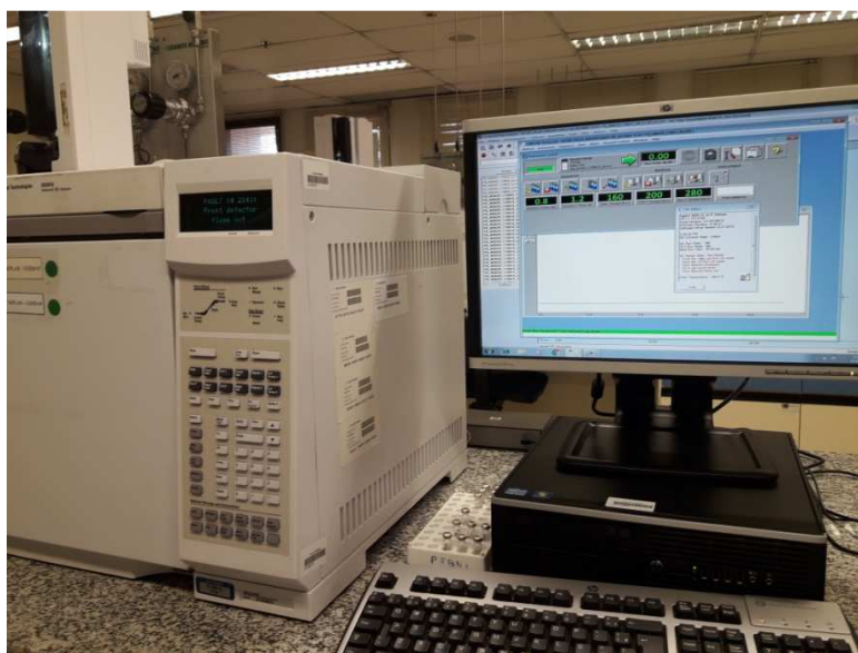
Figura 5 - Cromatógrafo Gasoso Agilent Technologies® 6890N com detector de ionização em chama acoplado a uma estação de trabalho com os softwares MSD ChemStation e Enhanced Data Analysis, ambos da Agilent Technologies®.
