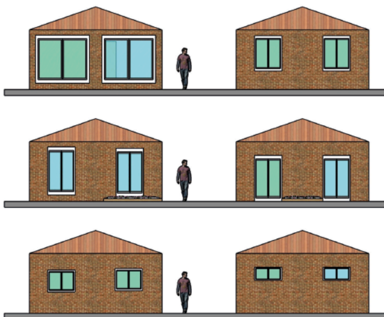
Figura 6 – Exemplos de habitações com o mesmo sistema construtivo e projeto arquitetônico com diferentes áreas envidraçadas na fachada.
