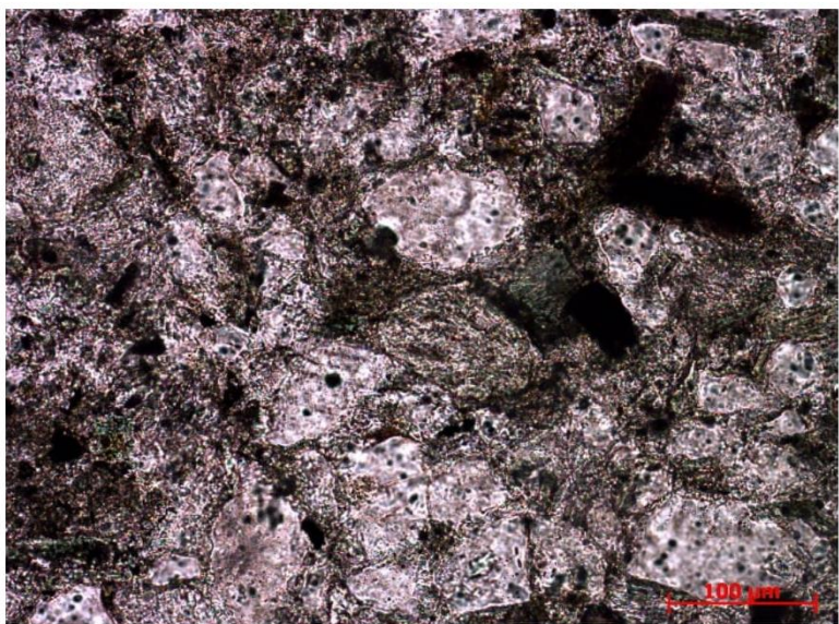
Grão de quartzo com filossilicato na borda. Plagioclásio com geminação polissintética e borda de corrosão (20x, nicóis cruzados).
