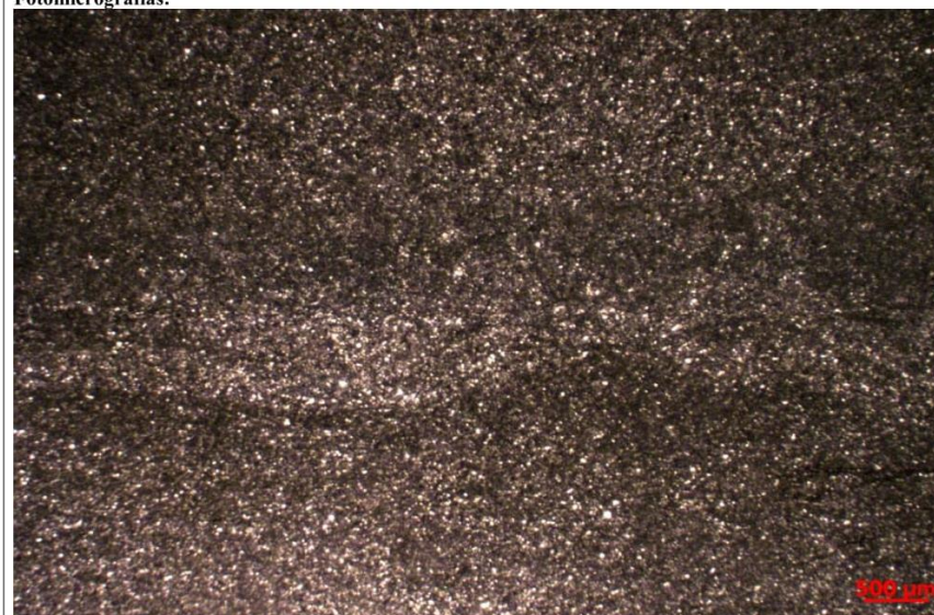
Laminação com superfície ondulada, percolação de fluidos durante a deposição (1,25x).
