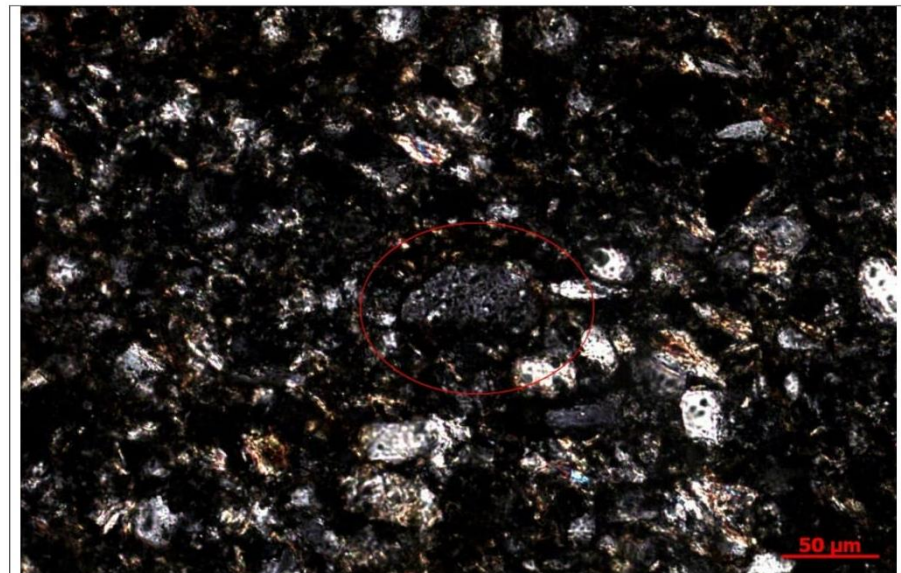
Provável grão de feldspato potássico alterado (20x, nicóis cruzados).
