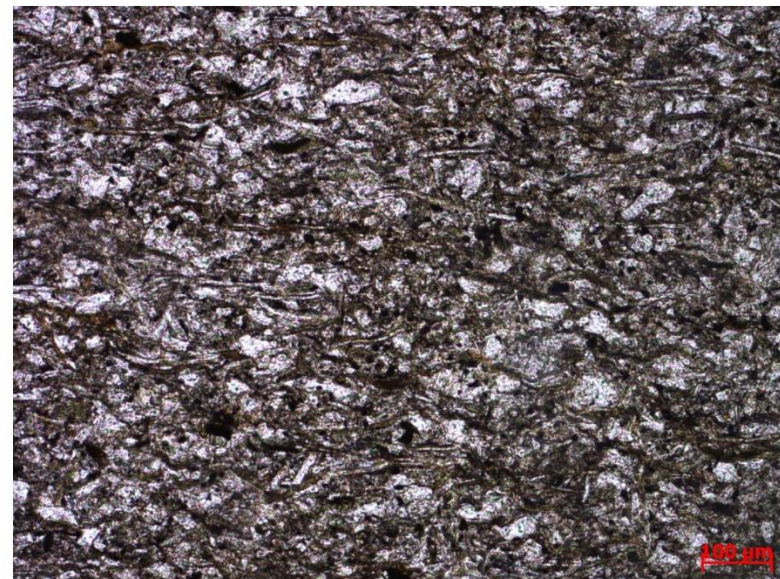
Orientação dos filossilicatos conforme direção preferencial paralela ao acamamento (10x, nicóis paralelos).
