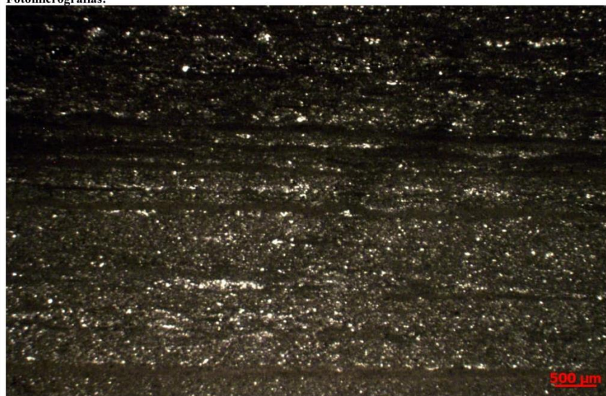
Laminação paralela com superfície irregular e estruturas microlenticulares (1,25x, nicóis paralelos).
