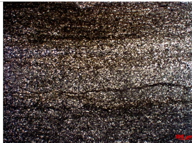
Laminação irregular, intercalação de lamelas argilosas e siltosas, efeitos da compactação diferencial (1,25 x, nicóis paralelos).
