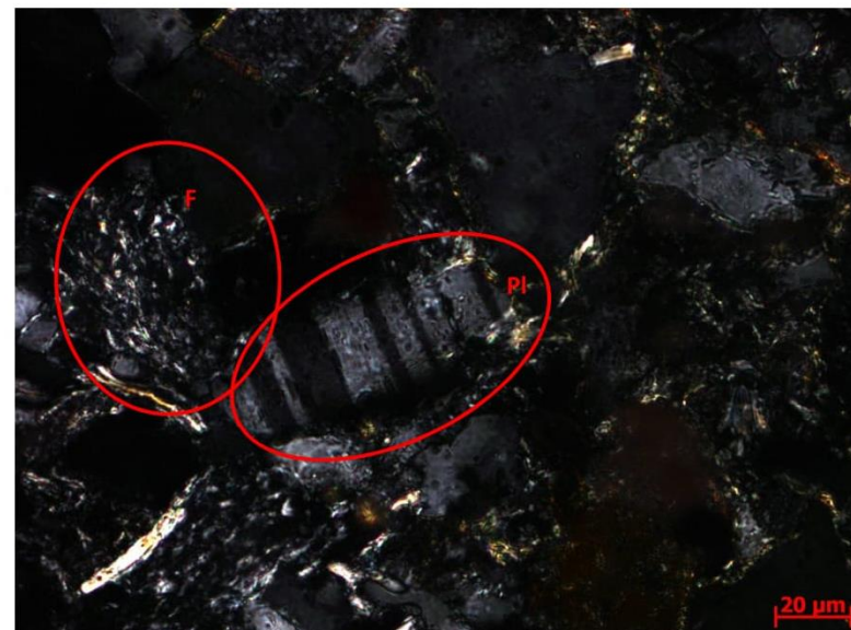
Grão de plagioclásio (pl) com palhetas de filossilicato no seu interior. Fragmentos líticos ou feldspatos alterados (F).
