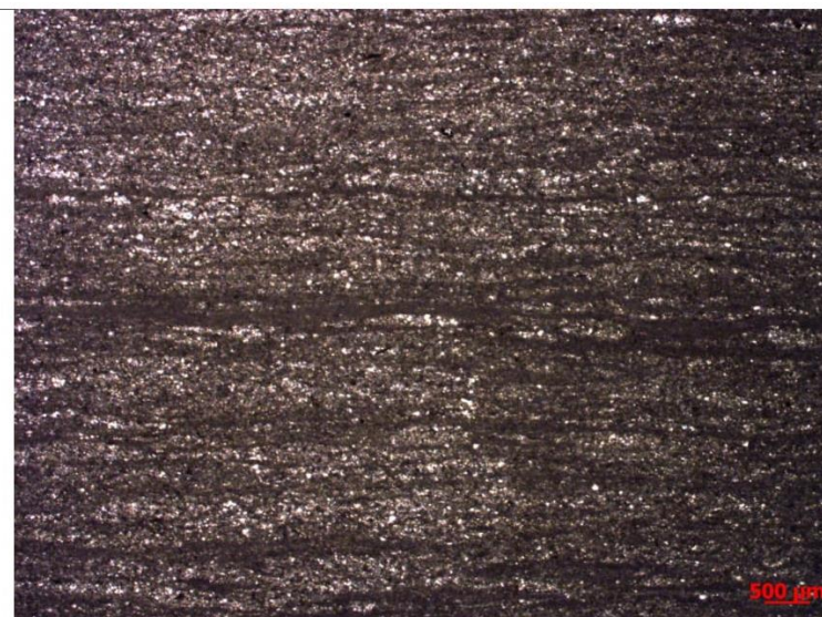
Microlentes siltosas em meio à lama argilosa (2,5 x, nicóis paralelos).
