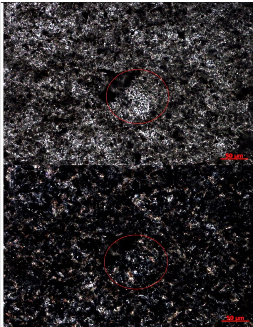
Feldspato potássico alterado ou fragmento lítico (20x, nicóis paralelos e cruzados, respectivamente).
