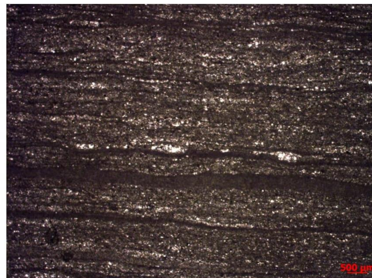
Microerosões em lâminas argilosas preenchidas por silte (2,5x, nicóis paralelos).
