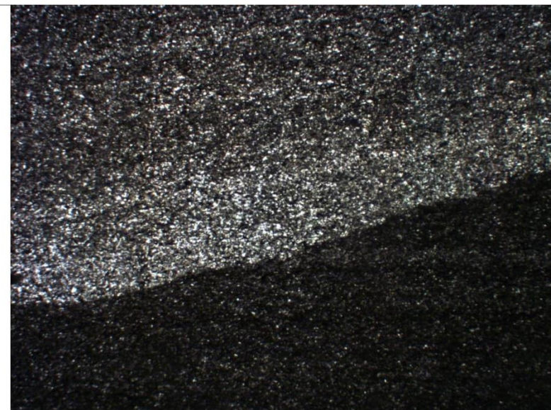
Marca ondulada entre um nível argiloso e um nível siltsoso (1,25x, nicóis paralelos).
