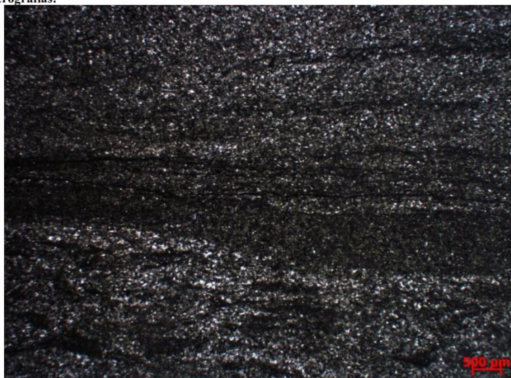
Laminação irregular e marca ondulada (1,25x, nicóis paralelos).
