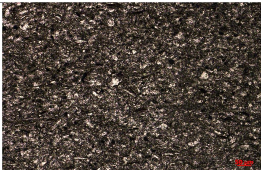
Lamelas de muscovita orientadas segundo três direções, sendo que duas são praticamente perpendiculares entre si no centro da fotomicrografia (10x, nicóis paralelos).
