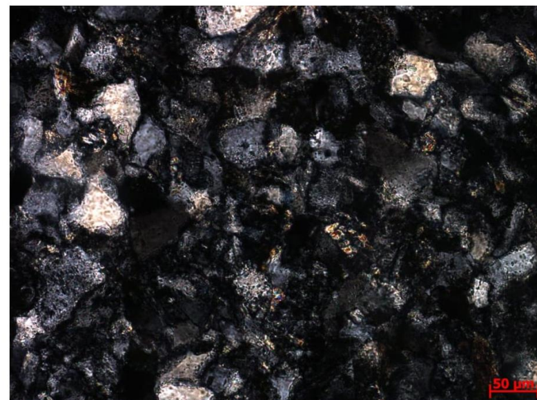
Grãos de quartzo monocristalinos com extinção fortemente ondulante (20x, nicóis paralelos).
