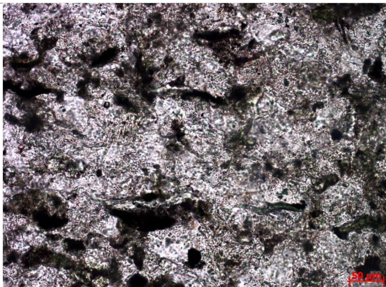
Orientação discreta dos filossilicatos e filmes de opacos. Notar clorita dobrada (20x, nicóis paralelos).
