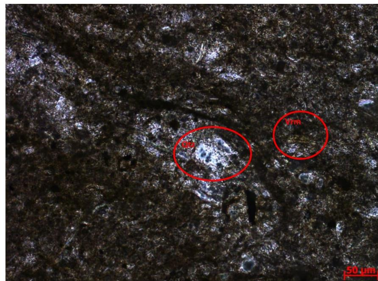
Grão de quartzo com borda de corrosão e grão anédrico de vermiculita (20x, nicóis paralelos).
