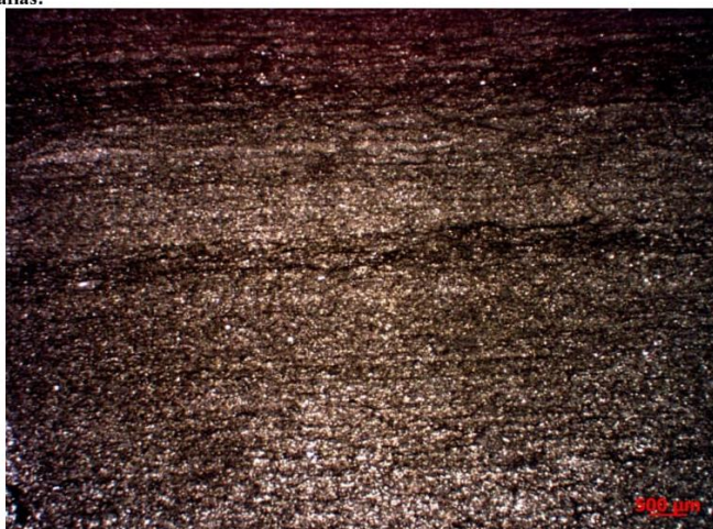
Laminação paralela com superfície irregular e efeitos de compactação diferencial (1.25x, nicóis paralelos).
