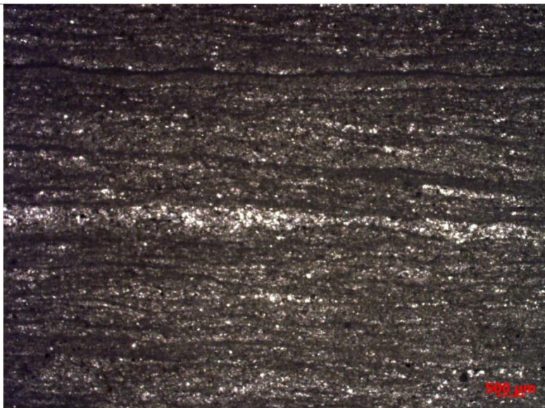
Intercalação de lâminas argilosas e siltosas (2,5x, nicóis paralelos).
