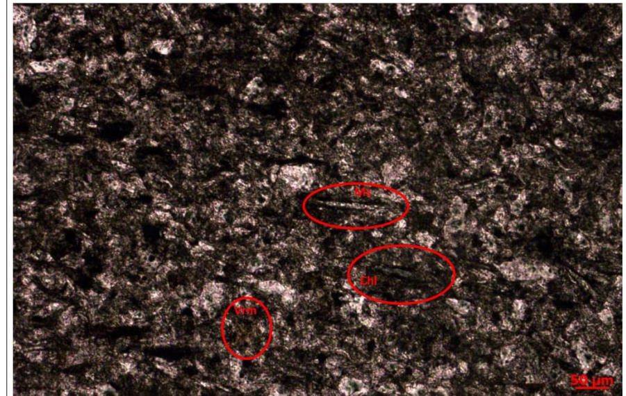
Lamelas euédricas de muscovita e clorita orientadas paralelamente ao acamamento e grão anédrico de vermiculita (10x, nicóis paralelos).
