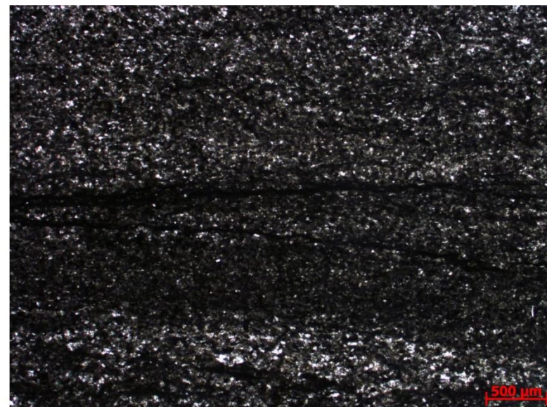
Laminação irregular ou superfície de microerosão (2,5x, nicóis paralelos).
