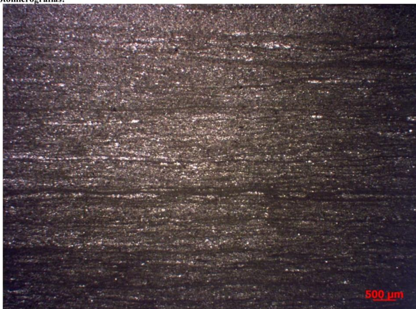
Laminação paralela com superfície ondulada, estruturas de microerosão e microlentilulares (1,25x, nicóis paralelos).
