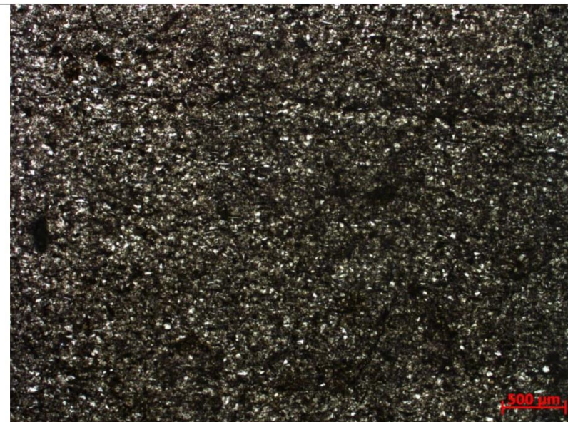
Laminação irregular e descontínua (2,5x, nicóis paralelos).
