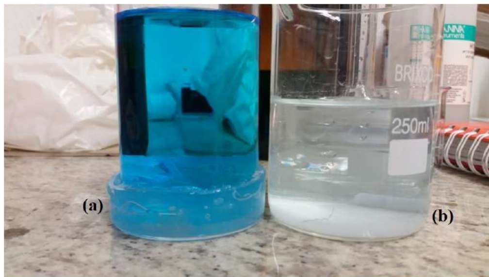
FIGURA 6.5: Fotografias da solução de azul de metileno nas etapas: (a) antes da irradiação e (b) após o processo de fotodegradação ( t \leq 60 min).
