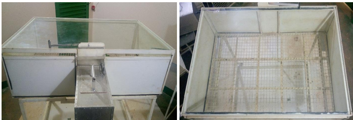
Figura 4: Fotografias do aparato experimental do Campo Aberto utilizado nos experimentos. Esquerda: Vista de trás do aparato, mostrando na parte inferior da fotografia a caixa transporte acoplada ao aparato e do outro lado a parede de vidro. Direita: Vista de cima do aparato, podendo ver o piso na cor branca para contrastar com a cor do animal e o teto de vidro. (Fotografias: Clarissa R. da S. Vannuchi)
