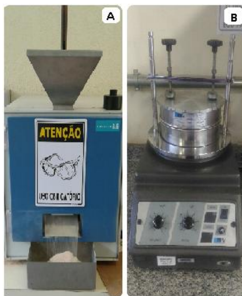
Figura 8. Preparo das amostras para caracterização química e poder calorífico. A) Moinho de facas do tipo willey. B) Agitador eletro-magnético de peneiras.
