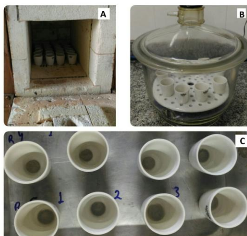
Figura 10. Sequência para obtenção de dados para a determinação do teor de cinzas. A) Amostras inseridas na Mufla. B) Após ensaio amostras em dessecador. C) Cinzas de biomassa de Pinus elliottii .
