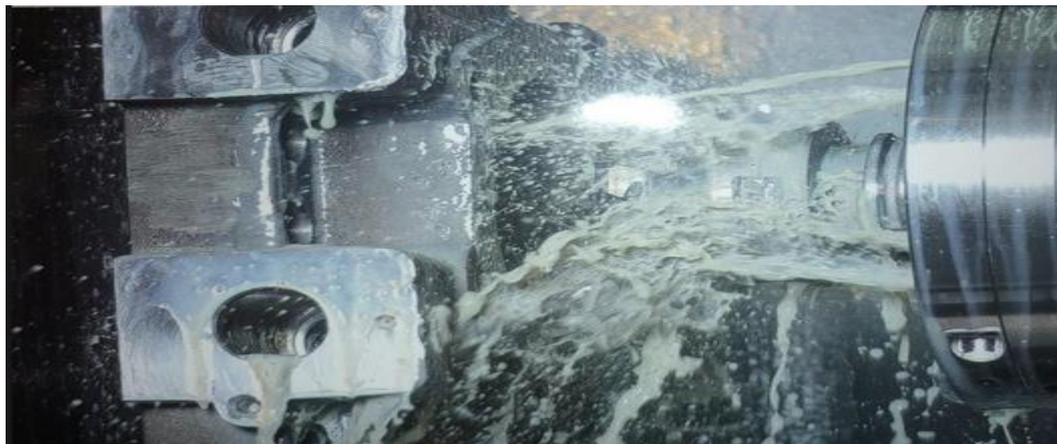
Figura 4 – Aplicação de um óleo vegetal em usinagem.<sup>21</sup>
