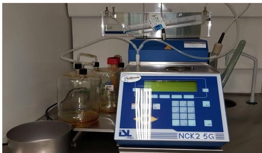
Figura 15 - Aparelho utilizado para medição da volatilidade dos óleos.
