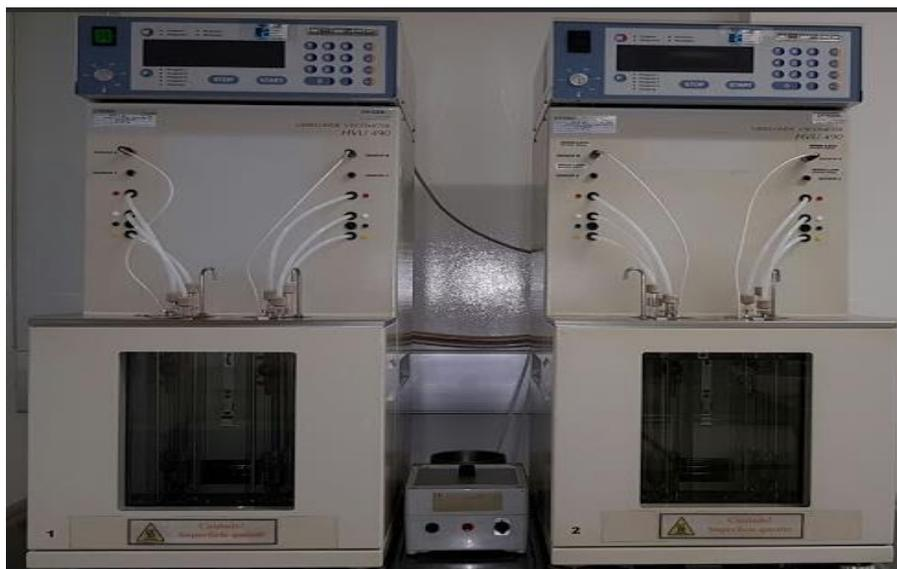
Figura 17 – Viscosímetros cinemático com banho a 40 °C e 100 °C.
