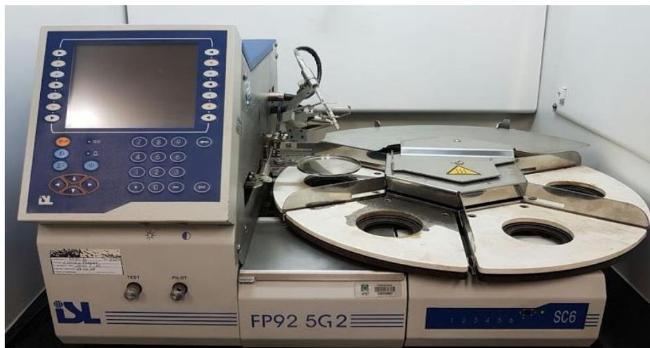
Figura 19 - Equipamento para medição do ponto de fulgor.
