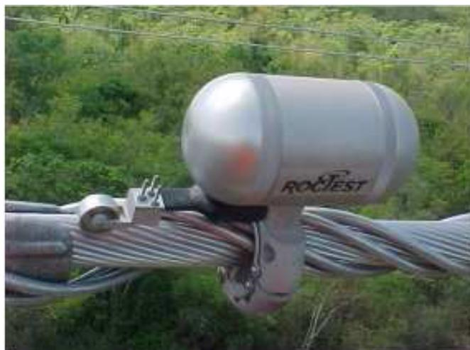
Figura 1.2 – Vibrógrafo do tipo Pavica montado em uma linha de transmissão (2)
