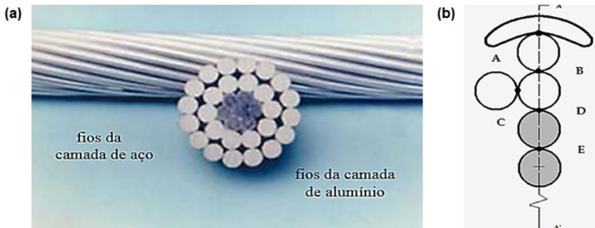
Figura 2.4 – (a) Foto de um cabo condutor ACSR em corte (a); (b) Regiões de contato.
