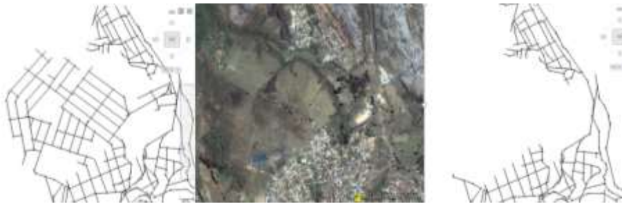
Figura 3.40 – Estratégia para construção dos mapas de expansão urbana: à esquerda, base cartográfica de 2017; ao centro, imagem do Google Earth ® de 2006; à direita, desenho com o conjunto de linhas apagadas, conformando a base de 2006 – Diamantina – MG. Crédito: Raquel Egídio/ Google Earth ® .
