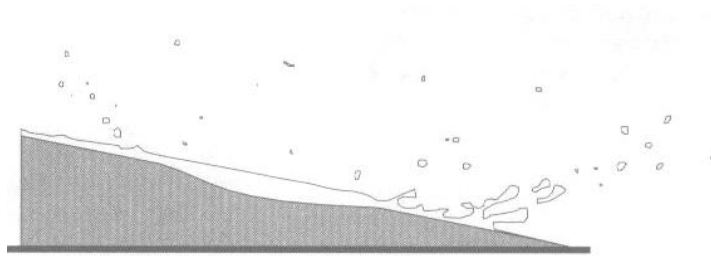
Figura 4: Erosão por salpimento em uma superfície de solo inclinada. Fonte: HILLEL (1998)
