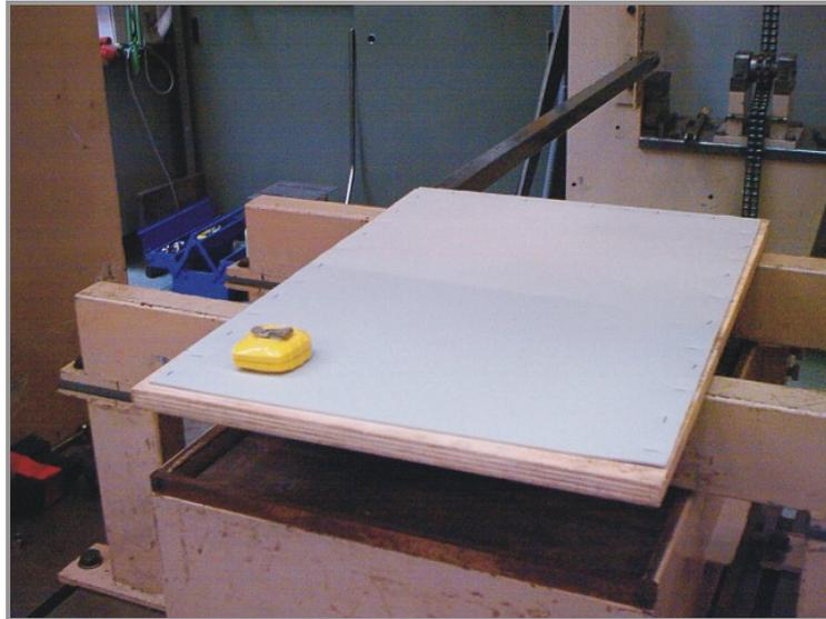
Figura 5.24 – Fixação da amostra de geomembrana de PVC-P para ensaio de cisalhamento direto com areia padrão.
