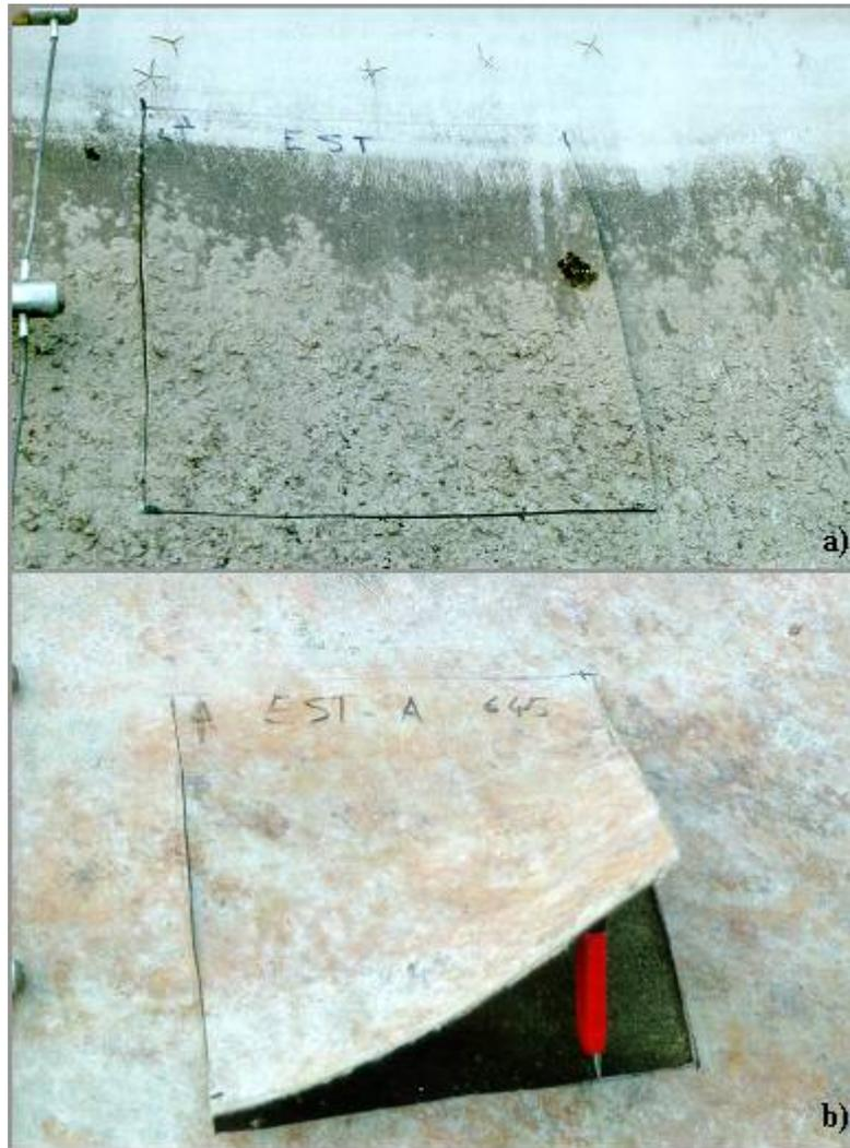
Figura 7.3 – Amostras de geomembrana exumadas no talude leste do Reservatório Pian Del Gorghiglio: a) zona de flutuação do nível d'água El. 648,6 m (MSE); b) zona submersa El. 645 m.
