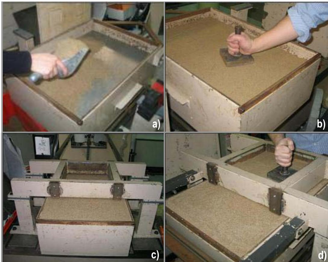
Figura 5.23 – Ensaio de cisalhamento na areia padrão.
