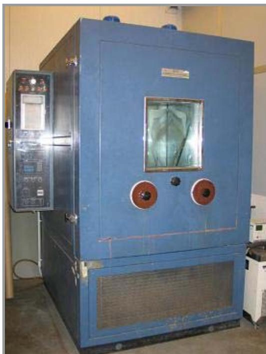
Figura 5.11 – Câmara fria utilizada no ensaio de flexibilidade a baixas temperaturas.
