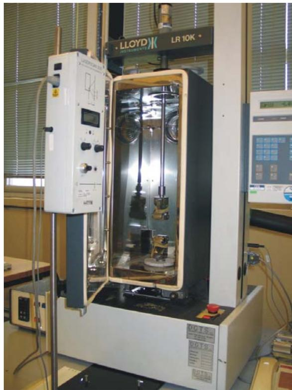
Figura 5.16 – Aparelhagem empregada para os ensaios de tração a diferentes temperaturas.
