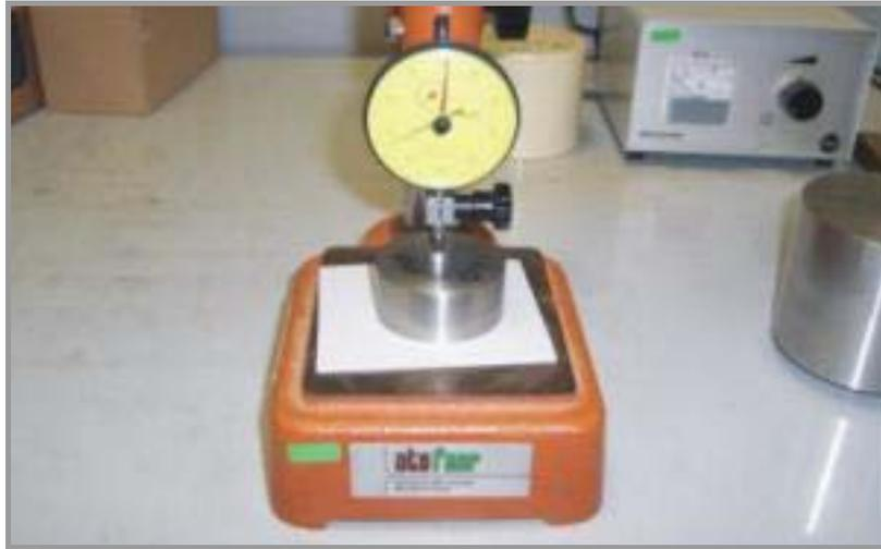
Figura 5.3 – Micrômetro para determinação da espessura nominal.
