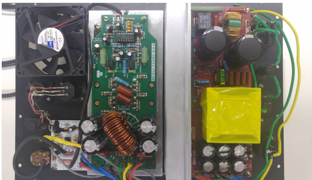
Figura 25 – Placa de circuito de amplificador de classe D Triell Audio Systems.
