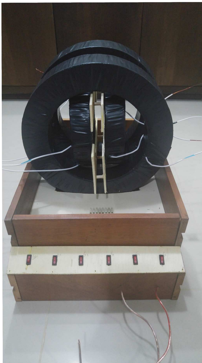
Figura 11 – Bobina de Helmholtz bidimensional e caixa suporte construídas para o presente trabalho. Os fios brancos são as entradas e saídas de cada bobina, e os fios avermelhados são as entradas e saídas da porção do circuito sob o suporte
