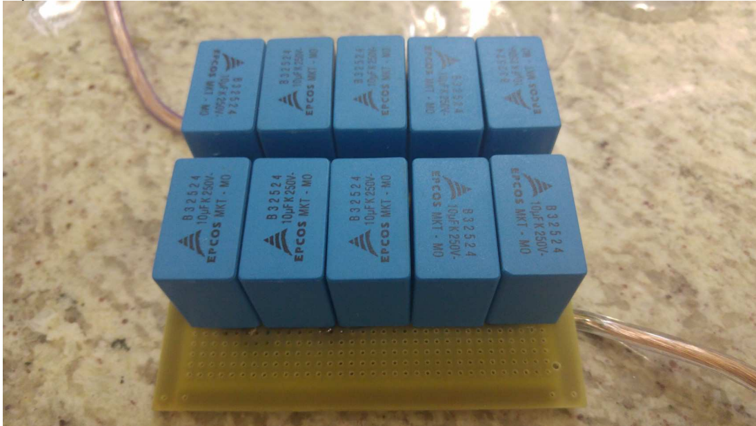
Figura 26: Banco de capacitores para circuito ressonante com capacitância equivalente a 25\mu\text{F}
