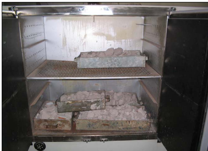
Fotografia 3.6 – Detalhe da estufa usada para secagem da amostra de RSCD.
