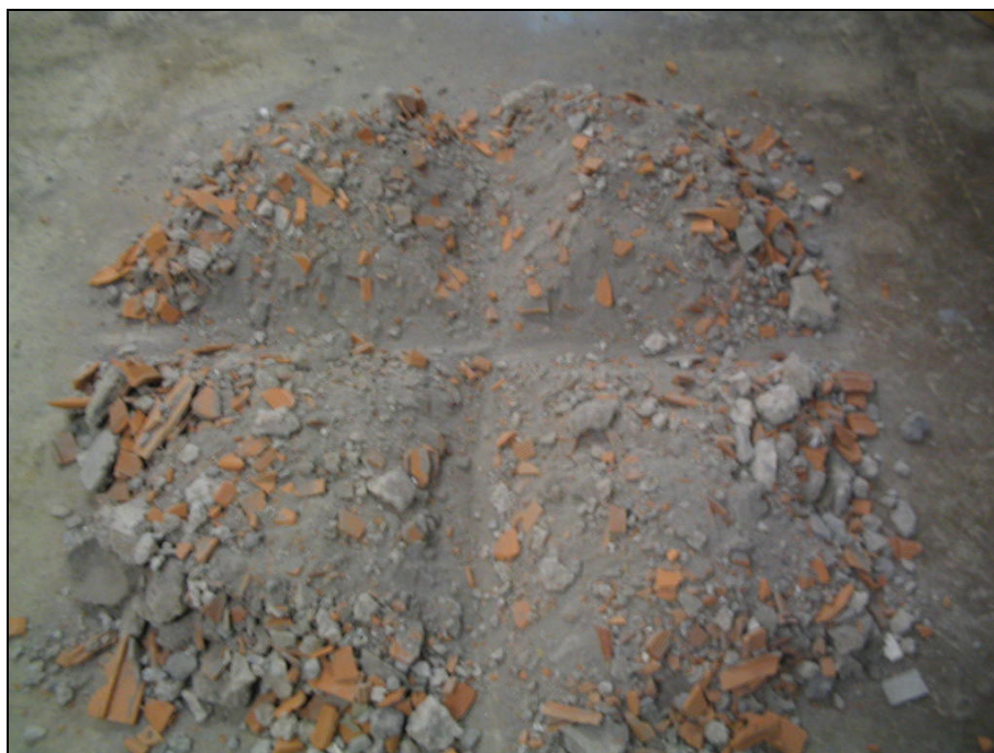
Fotografia 3.5 – Detalhe da amostra depois de quarteada.
