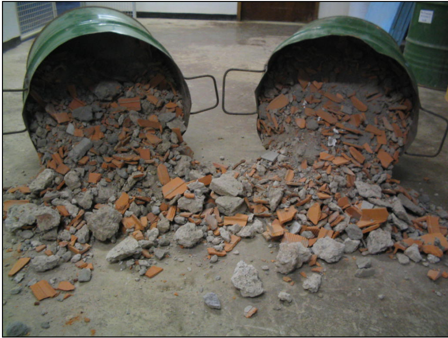
Fotografia 3.3 – Detalhe dos tambores de coleta com amostra de RSCD.
