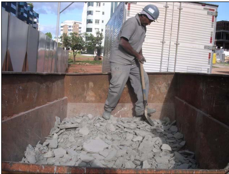
Fotografia 3.1 – Coleta de amostra parcial dentro da caçamba.
