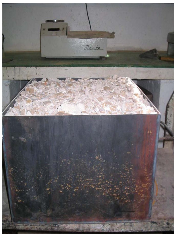
Fotografia 3.9 – Detalhe do recipiente paralelepípedo cheio, pronto para pesagem.
