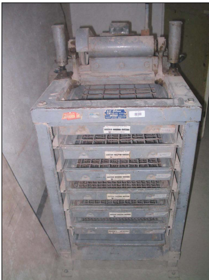
Fotografia 3.11 – Peneirador mecânico da marca GILSON.
