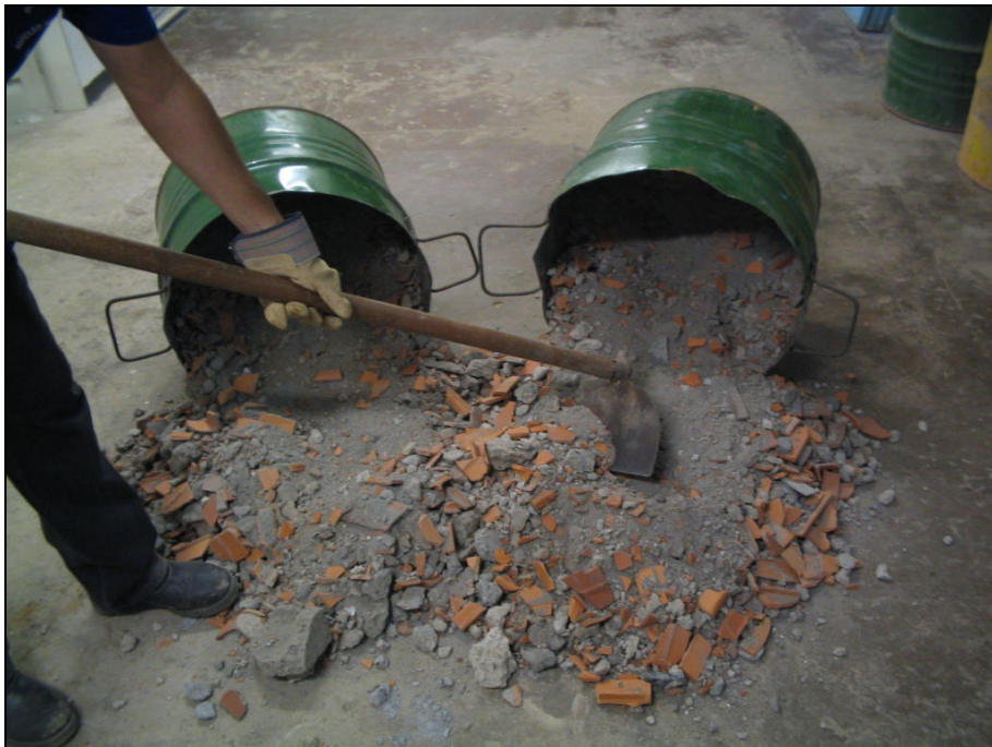
Fotografia 3.4 – Detalhe da homogeneização da amostra.
