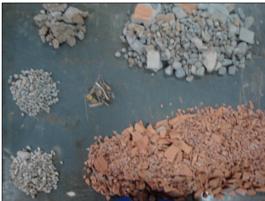
Fotografia 3.17 – Pilhas de componentes (partículas de dimensão igual ou superior a 4,8 mm).
