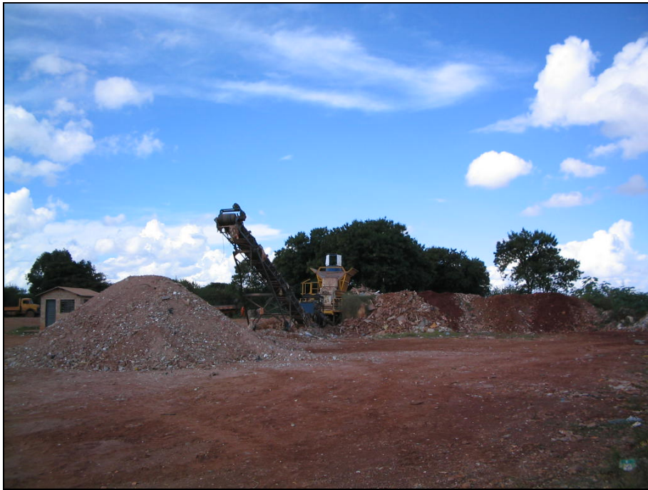
Fotografia 4.8 – Vista geral da mini-usina de beneficiamento de RSCD dentro do aterro do Jóquei Clube.
