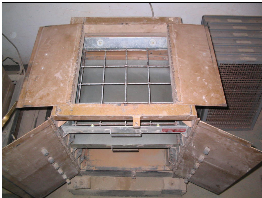
Fotografia 3.10 – Peneirador mecânico da marca SOILTEST.
