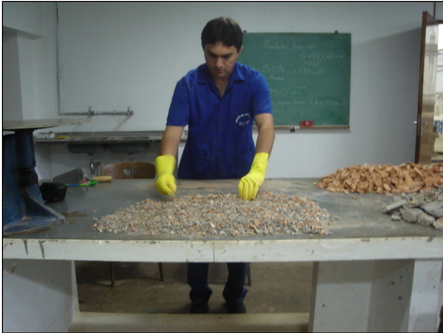
Fotografia 3.12 – Processo de catação dos componentes das amostras.
