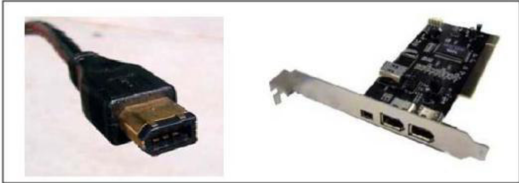
Figura 24: Dispositivos para conexão FireWire – da esquerda para direita: cabo FireWire, placa de conexão FireWire PCI. (Fonte: http://lista.mercadolivre.com.br/firewire ).
