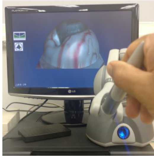
Figura 38: Retorno de força através da interface háptica.
