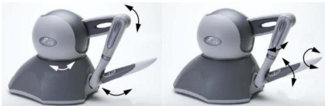
Figura 23: Phantom com 6 graus de liberdade: movimentos possíveis de serem realizados com o dispositivo háptico.
