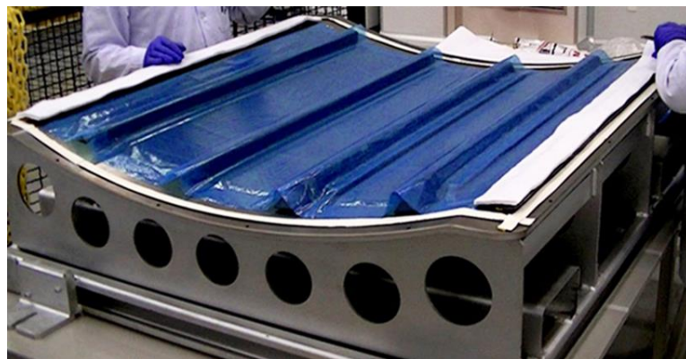
Fig. 34. Método de fabricação por Co-curing Process Método de fabricação em bloco composto por múltiplas camadas de compósitos por prensagem ou projeção de raios Ultra Violeta Fonte: http://www.ipt.br/noticia/1047-aeronautical_technology_.htm
