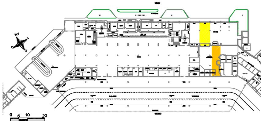
Figura 94 - ASG – localização das áreas onde foram realizadas as medições de iluminâncias no pavimento térreo: Praça de Alimentação e Sala de Embarque. (Fonte: adaptado de ASG, 2006)
