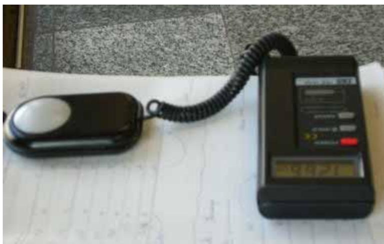
Figura 28 - Equipamento de medição – luxímetro digital utilizado nas medições in loco
