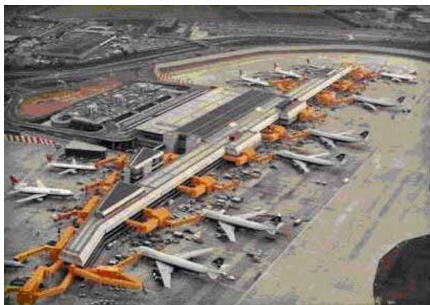
Figura 6 - Terminal linear – Terminal 4 do aeroporto de Heathrow, Londres (ROUTE79,2006)
