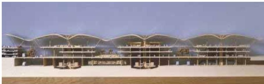
Figura 18 - Corte esquemático do Aeroporto Barajas em Madri, mostrando os dispositivos de controle de luz natural. (RICHARDROGERS, 2006)
