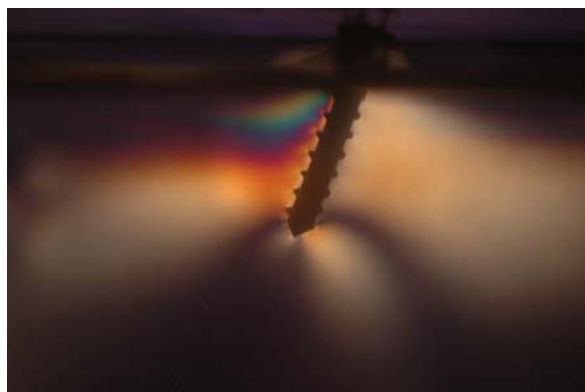
Figura 4: Tensões produzidas após aplicação de carga lateral pelo mini-implante cilíndrico.
