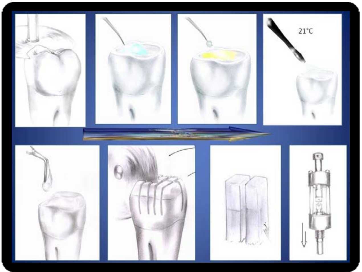
Figura 2 – Desenho esquemático do preparo dos espécimes para o grupo I – Corte da superfície oclusal do dente, condicionamento com ácido fosfórico, aplicação do sistema adesivo, evaporação do solvente a 21°C, confecção da coroa de resina, cortes e obtenção dos espécimes em forma de palitos para o ensaio mecânico.
