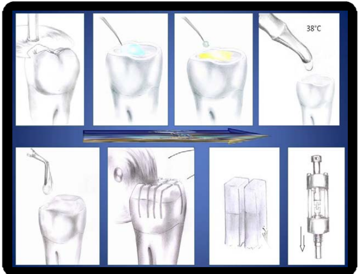
Figura 3 – Desenho esquemático do preparo dos espécimes para o grupo II – Corte da superfície oclusal do dente, condicionamento com ácido fosfórico, aplicação do sistema adesivo, evaporação do solvente a 38°C, confecção da coroa de resina, cortes e obtenção dos espécimes em forma de palitos para o ensaio mecânico
