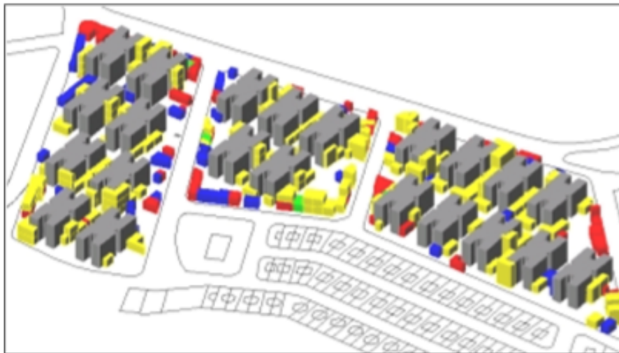
Figura 40. Conjunto Habitacional Curado III. Imagem 3D – Configuração original e a resultante das intervenções efetuadas pelos moradores. Fonte: MONTEIRO, 2000.
