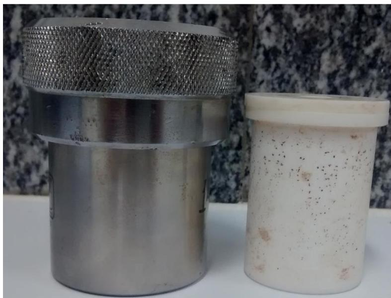
**Figura 15** – Reator para síntese hidrotermal utilizado na obtenção de cristais de NaYF<sub>4</sub>.
