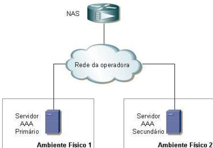
Figura 4.1: Servidores AAA instalados em ambientes distintos.
