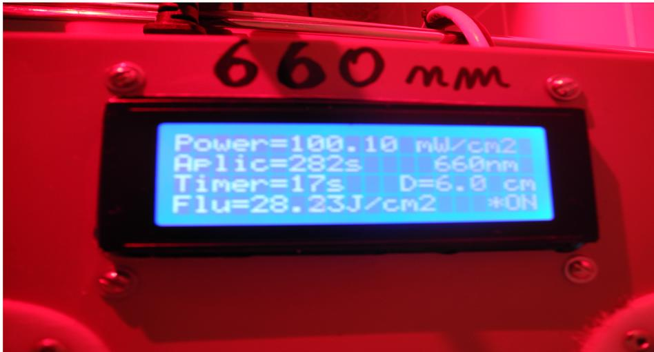
Figura 4. Padronização da fonte luminosa utilizada nas sessões de TFD combinada a nanoemulsão de AICIFc. Comprimento de onda: 660 nm. Potencia 100 mW/cm<sup>2</sup> .
