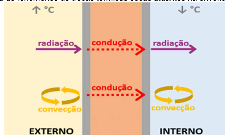
Figura 11: Esquema de fenômenos de trocas térmicas secas atuantes na envoltória.
