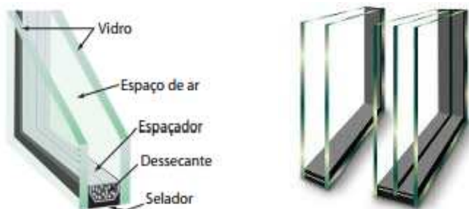
Figura 27: Composição de vidros insulados.
